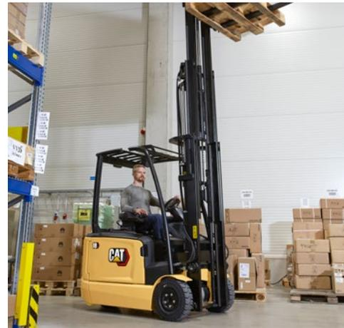
El sistema hidráulico con detección de carga ajusta el peso manejado para mantener un control preciso. El control de oscilación pasivo mantiene abierto el freno de estacionamiento automático para que la energía de oscilación del mástil sea absorbida por el peso total de la carretilla. Todos los mástiles y el desplazador lateral de baja fricción minimizan la oscilación, torsión y ruido.
